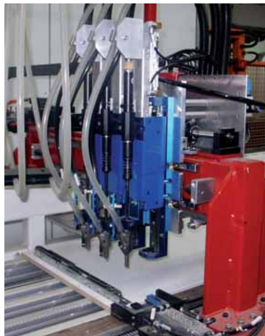
UNIQUICK® unità di avvitatura a mandrini multipli nell'industria del mobile e del legno
