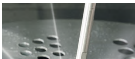
2a marcia - media potenza della pompa Ad esempio, per la pulizia di tubi e fasci di tubi
